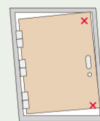
建物变形時にドア枠とドアが接触して、開かなくなる可能性があります。
