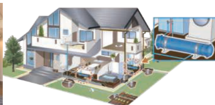
飲料水貯水システム 床下給水経路内に常に新鮮な飲料水を備蓄し、断水時には容易に取水が可能
